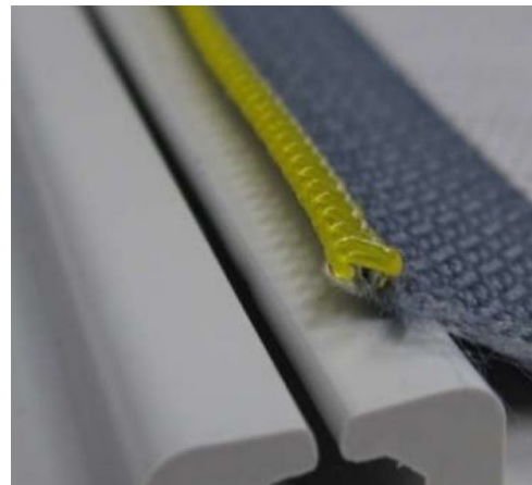
Bild 2. Um die Zip-Screens seitlich straff führen zu können, ist ihre verstärkte Aussenkante mit Noppen aus einem Kunststoff mit guten Gleiteigenschaften versehen. Diese werden in Kunststoffprofilen geführt.
